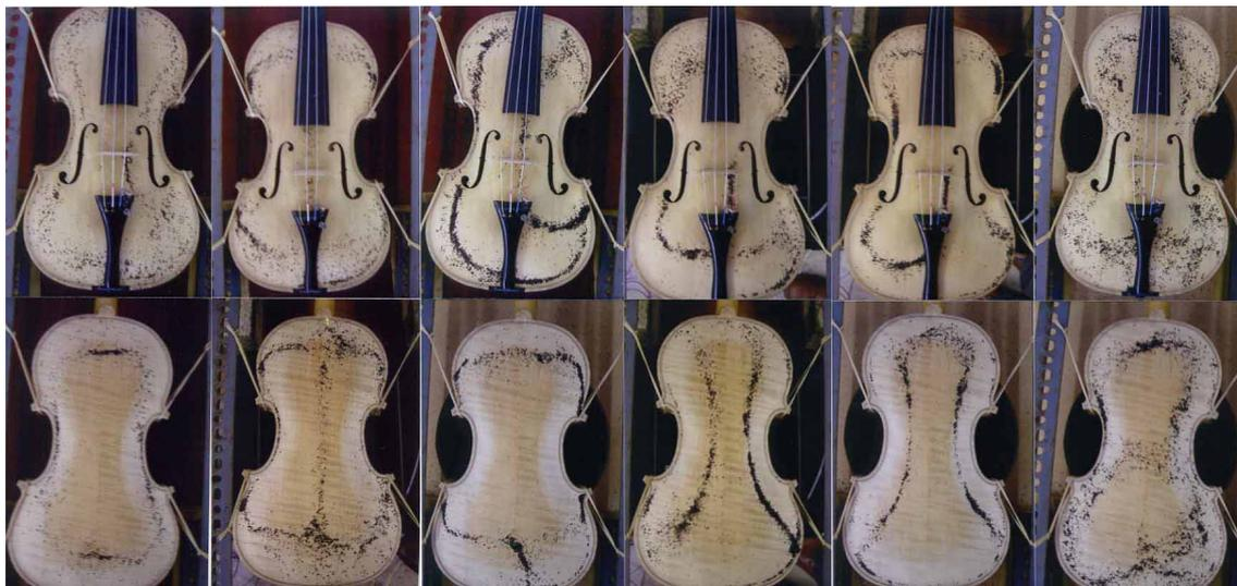
A0 285 Hz    C2 385 Hz    B1- 422 Hz    B1+ 528 Hz    C4 600 Hz    ? 852 Hz
