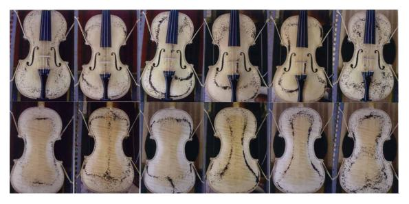
A0 285 Hz C2 385 Hz B1- 422 Hz B1+ 528 Hz C4 600 Hz ? 852 Hz
